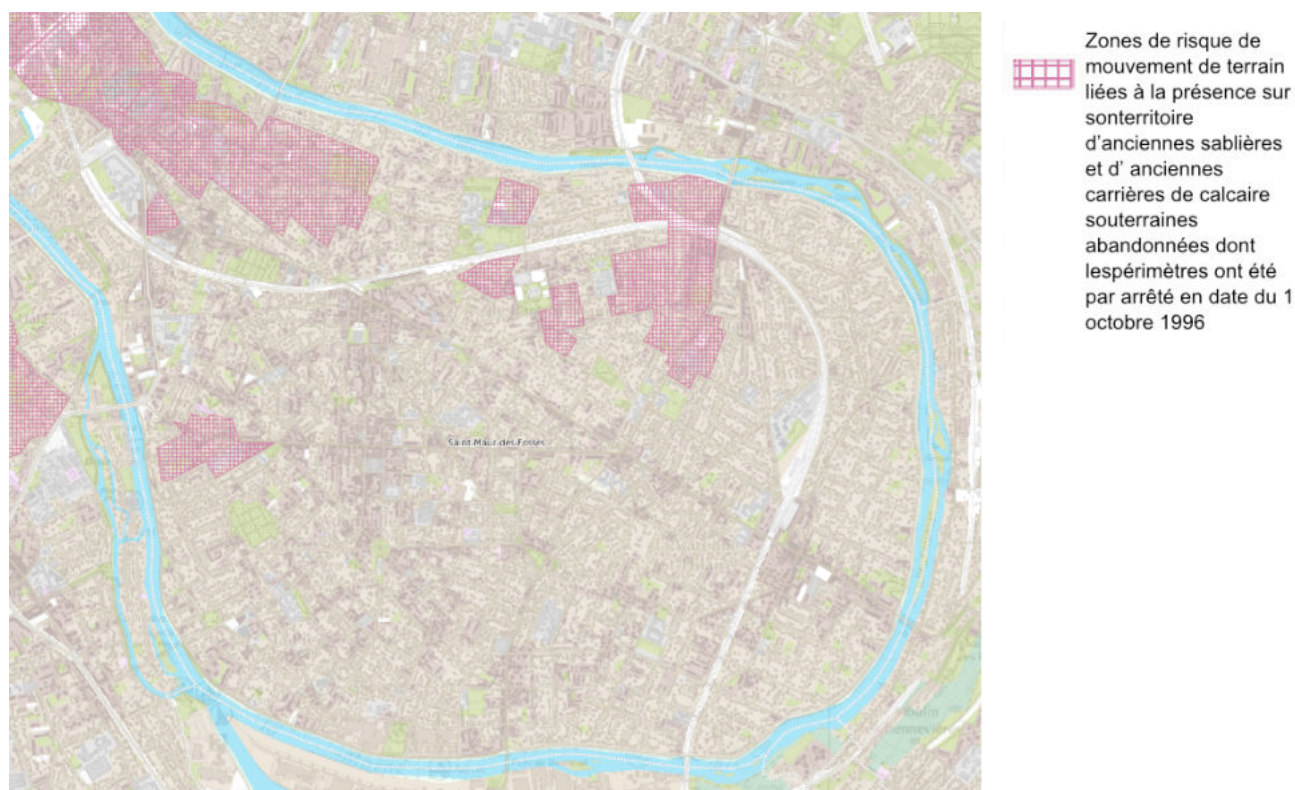
Zones de risques de mouvements de terrains liées aux anciennes carrières (source IAU Ile-de-France, 2015)
